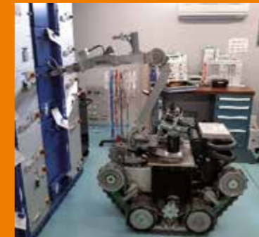
Evolution d'EOLE manœuvrant une cane de disjoncteur dans un local électrique
