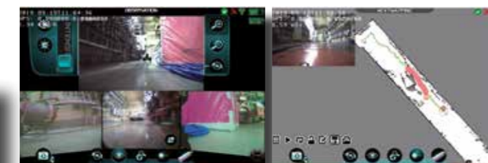
Retour des informations sur l'écran de la console de pilotage du robot Nerva ainsi que du cheminement du robot. On peut remarquer un passage « légèrement » irradiant concrétisé par la couleur rouge.
