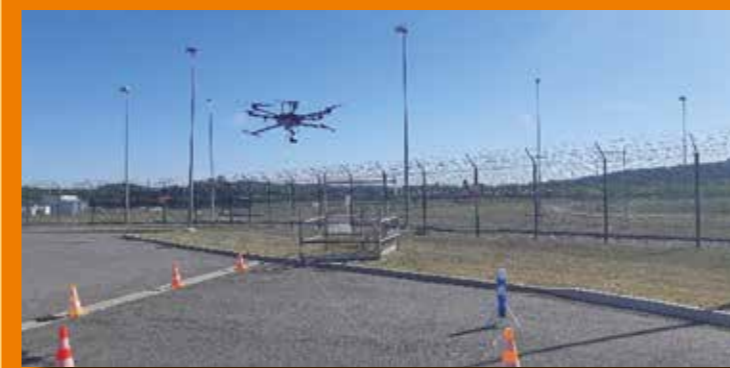
Drone au décollage au-dessus de la balise de surveillance à transporter
